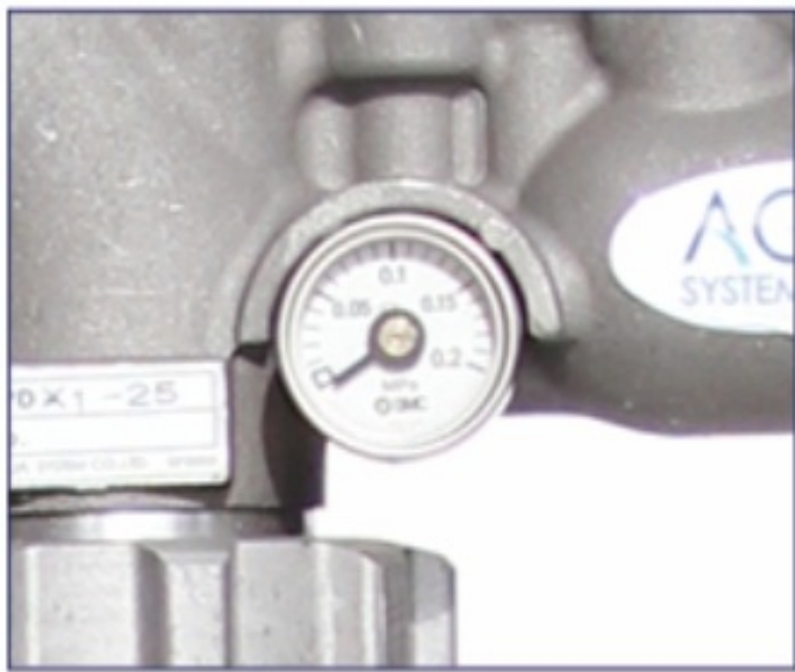
外置压力表，压力显示可视化。
