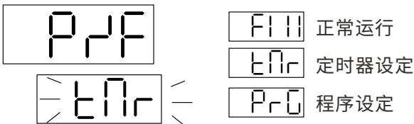
●按下MODE键进入温度设定画面，使用UP/DOWN/SHIFT键来调整温度设定值，再次按下MODE键来确定。
